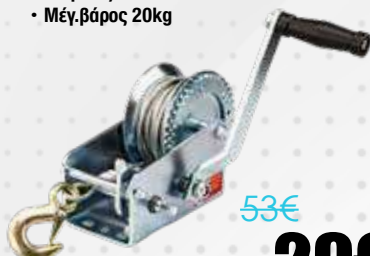
BWR5190 028505 ΕΡΓΑΤΗΣ ΧΕΙΡΟΚΙΝΗΤΟΣ • 900Kg • Συρματόσχοινο • 5mmx10m
