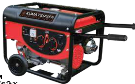
GB8500MP Γεννήτρια βενζίνης τροχήλατη με μίζα • 420cc • Μέγιστη απόδοση 8.1kVA • Πρίζες 2x16A, 1x 12VDC
